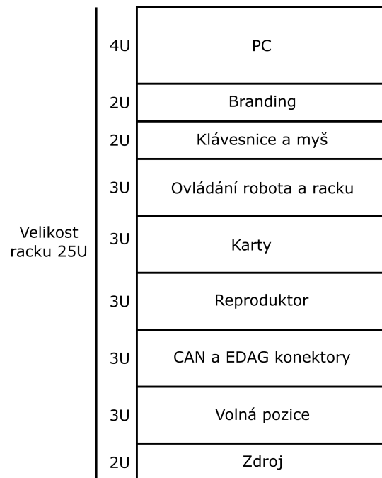
Obr. B.1: Obsazení - rack
