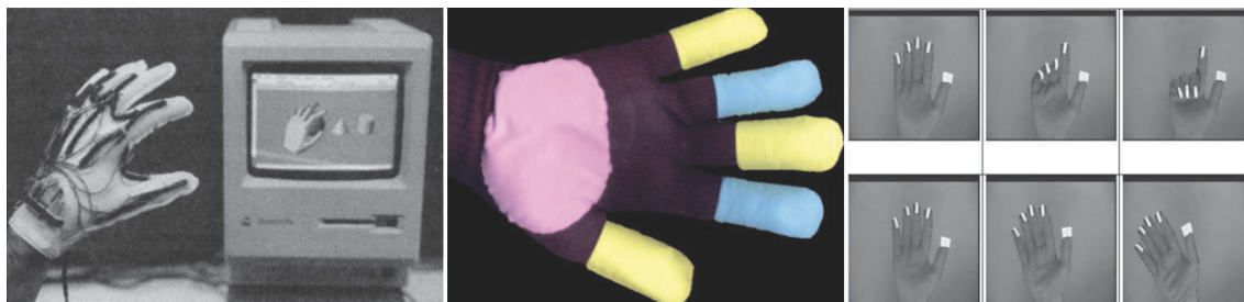
Obrázek 3.1: Vlevo raný prototyp datové rukavice Z TM Glove (Zimmerman, 1982), vprostřed model jednoduché barevné rukavice a vpravo ukázka metody založené na hledání markerů. Zdroj: [1]
