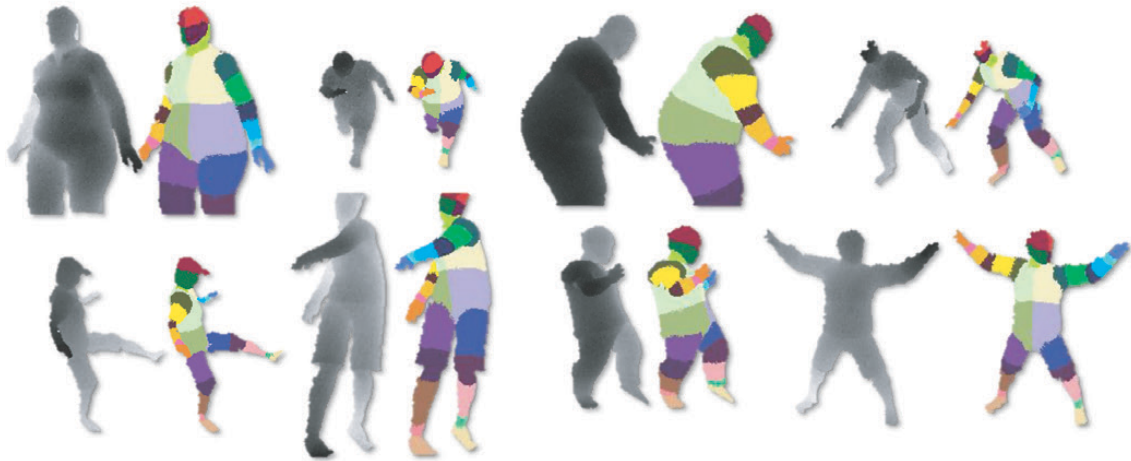
Obrázek 4.2: Ukázka robustní klasifikace hloubkových snímků těla na jednotlivé části metodou Random Forest. Zdroj: [7]
