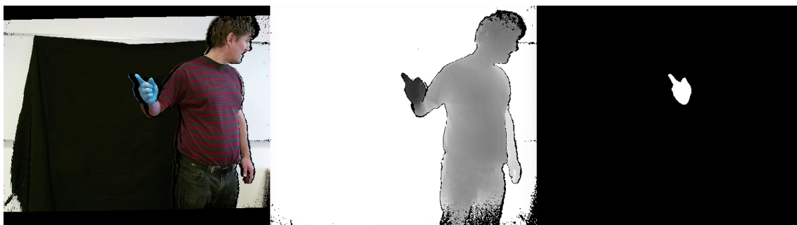
Obrázek 9.3: Ukázka segmentace reálné ruky před černým plátnem. Vlevo je barevný obrázek synchronizovaný s hloubkovou mapou, veprostřed vidíme hloubkovou mapu a vpravo konečně vysegmentovaný objekt ruky.
