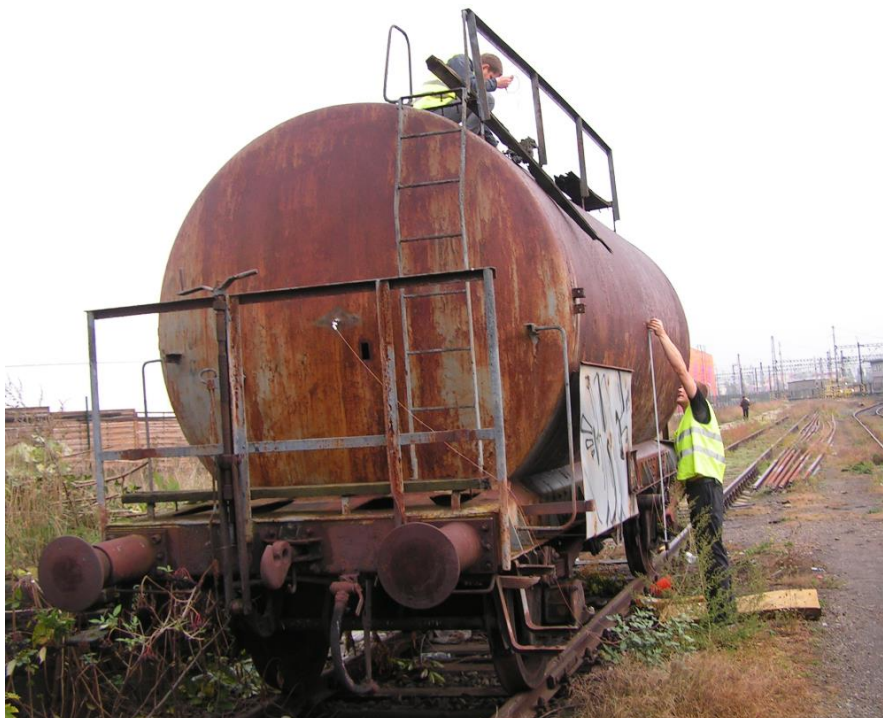
Obr. 8.1 Fotografie zachycující vyměřování poloh pro snímače. Na čelní stěně cisterny lze vidět jeden ze snímačů (H1).
