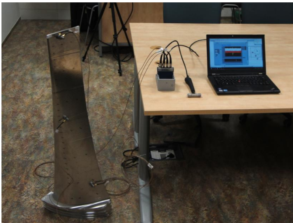
Stanoviště experimentu na turbínové lopatce. Na fotce je vidět lopatka osazená třemi snímači, měřicí karta, impulsní kladívko a notebook s programem pro sběr a ukládání dat.
