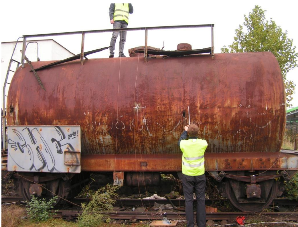
Boční pohled na cisternový vůz. Na zemi v popředí je vidět měřicí karta. Ve střední části fotografie je vidět čidlo H2 umístěné na boku cisterny.
