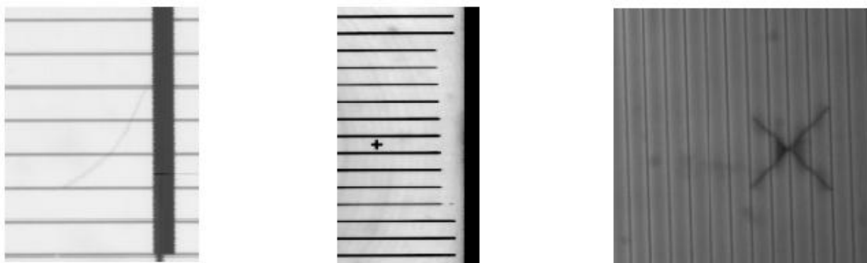
Obr. 2.5 – zobrazení defektů (zleva) poškrábání, výskytu prachových částic a skrytého lomu, převzato z [15]
