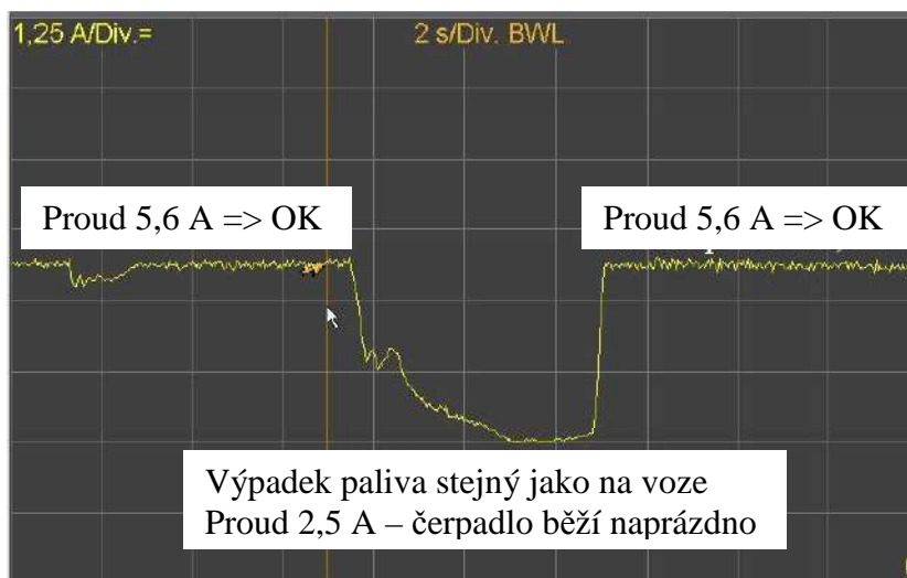
Obr. 57: Průběh odběru proudu při simulaci závady
