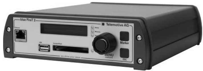
Obr. 2: Dataloger Blue PiraT2 převzato z (26)
