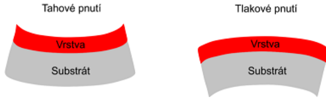
Obr. 4.6: Schématické zobrazení účinků tahového a tlakového pnutí na materiál. Upraveno dle [26].
