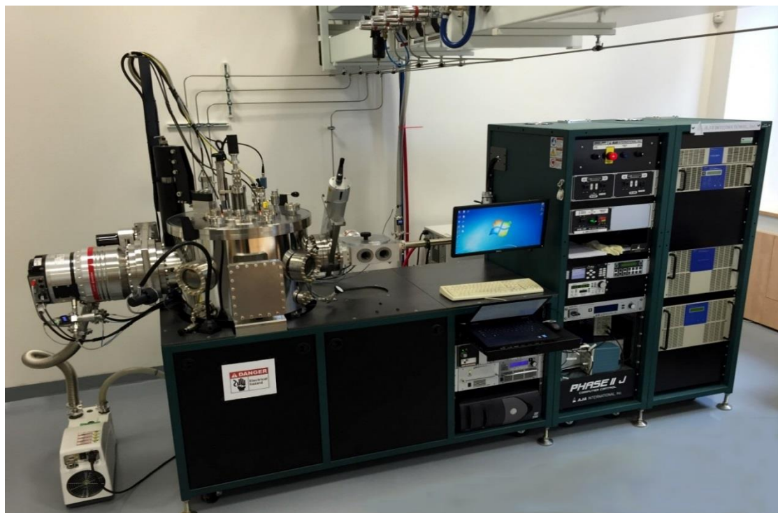
Obr. 17: Fotografie systému ATC 2200-V Sputter System od společnosti AJA International, Inc. používaného na KFY ZČU.
