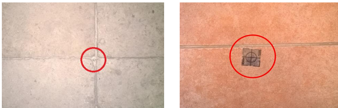
Obr. 11: Ukázka stabilizace bodů měřické sítě. (Foto: Kateřina Halíková)
