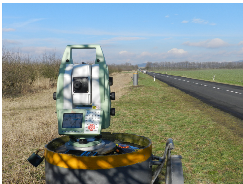
Obrázek 9: Leica Nova MS50 při kalibračním měření
