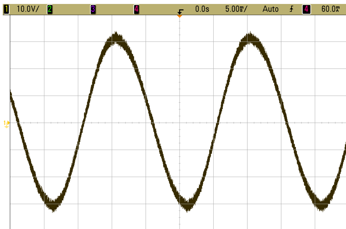
Obr. 6.3 Napětí na výstupu na prázdnou
