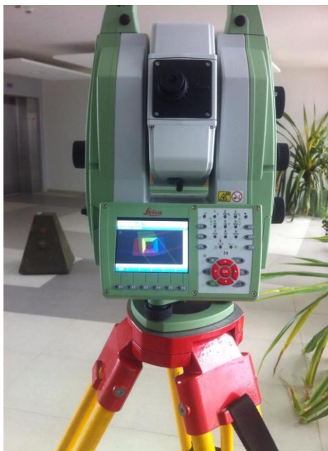
Obr. 4.3 Leica Nova MS 50 MultiStation a zobrazení skenů na displeji přístroje
