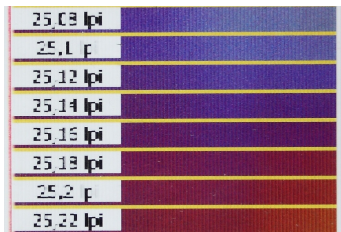
Obrázek 3.8: Ukázka několika barevného pitch testu s lentikulární deskou
