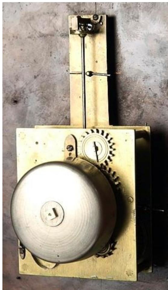
Obr. 20 Stroj oltářových hodin, Marcus Böhm, kolem 1685 (AHC)
