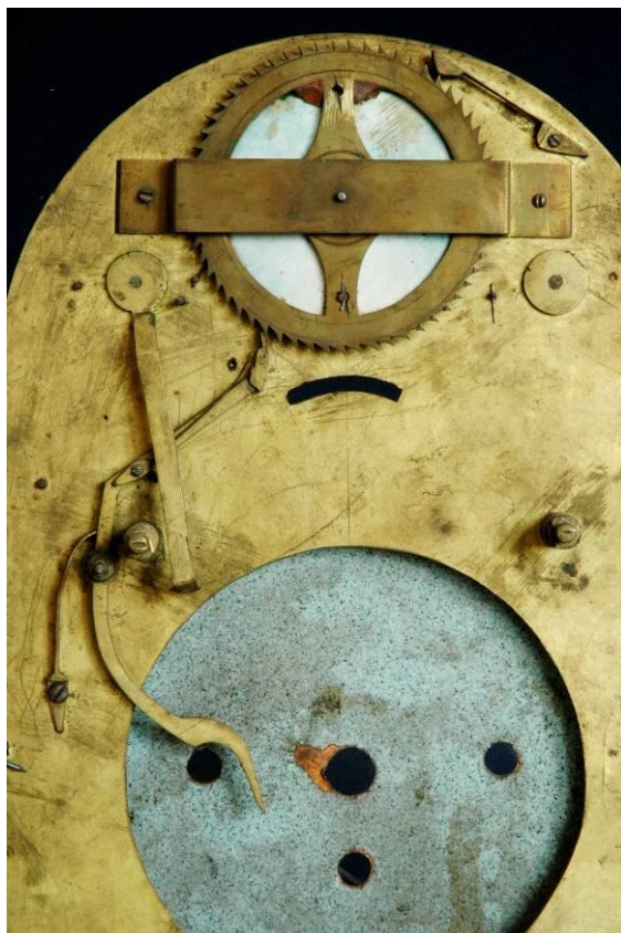
Obr. 50 Mechanismus ukazatele lunárního cyklu (MCKB H 2430)
