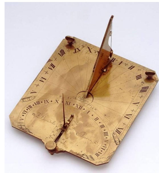
Obr. 40 Horizontální a analematické sl. hodiny, Nicolas Baradelle, konec 18. stol. (NMM AST0301)
