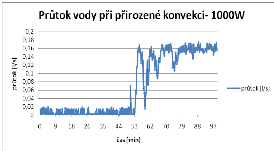
Graf 9: Průtok vody při přirozené konvekci v závislosti na čase pro výkon 1000 W
