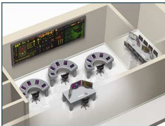
Obr. 7. Koncept hlavní řídicí místnosti NuScale pro 12 modulů [24, str. 9].
