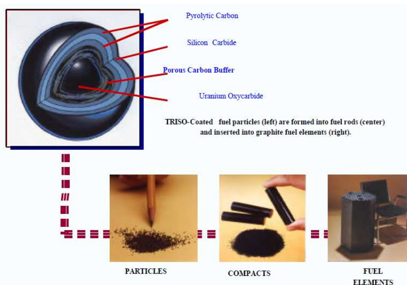
Obr. 30. TRISO palivo u GT-MHR [22, str. 456].
