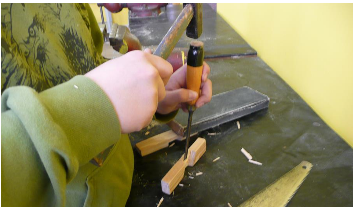
Obrázek 17 Dlabání výběru ramene
