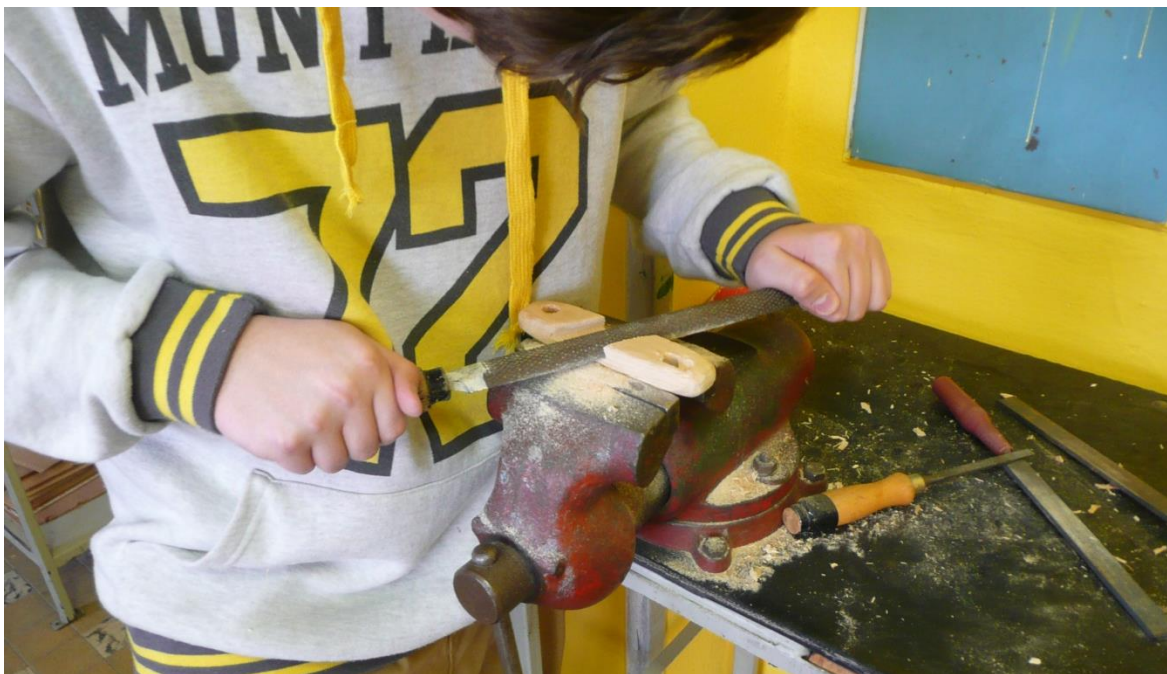
Obrázek 19 Úprava rozměru výběru pomocí rašple
