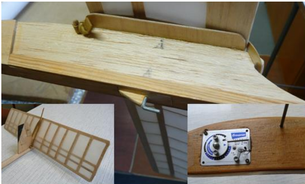
Obrázek 11 Těžiště na trupu modelu s vlekačím háčkem, vyklopené výškové kormidlo a časovač
