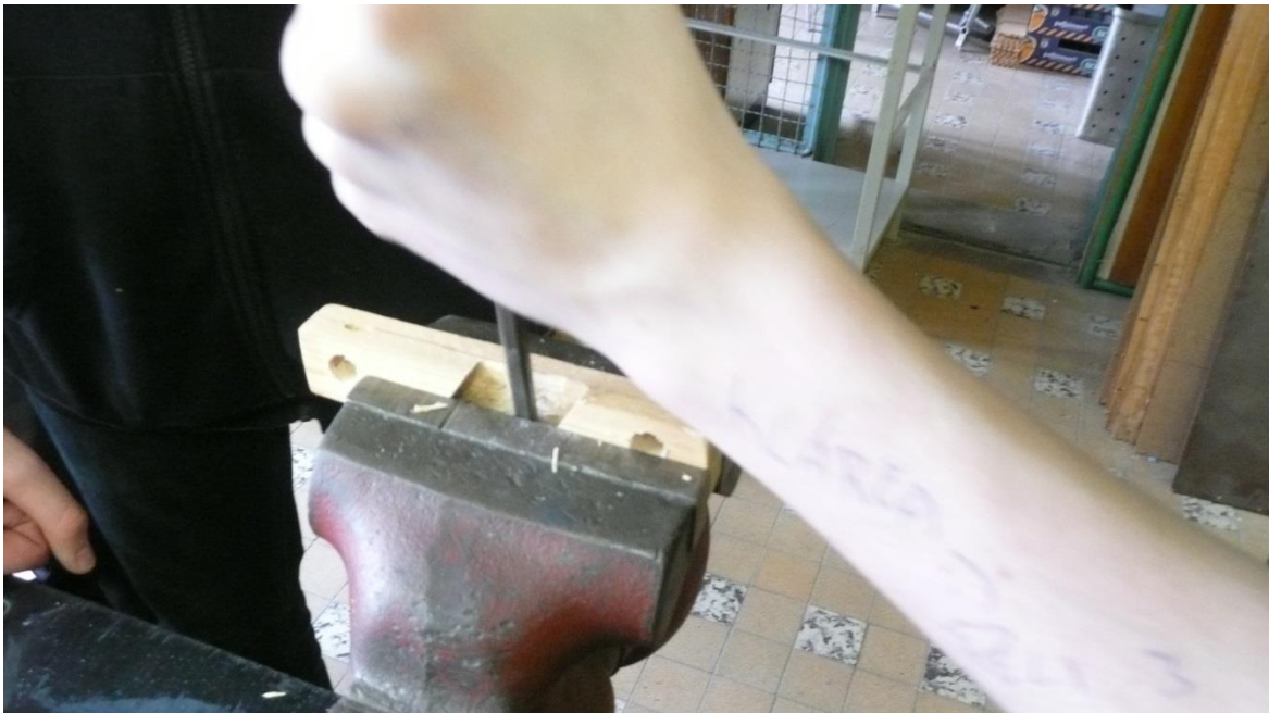
Obrázek 18 Nesprávné upnutí materiálu při dlabání výběru
