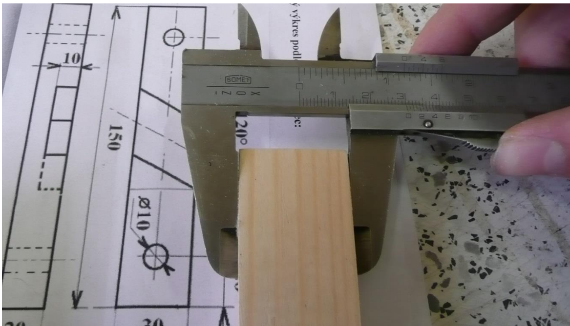
Obrázek 26 Kontrola rozměrů během výroby členem modeláře
