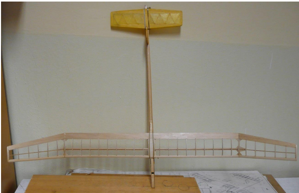
Obrázek 10 Model kategorie A3 Tintítka s nepotaženými křídly
