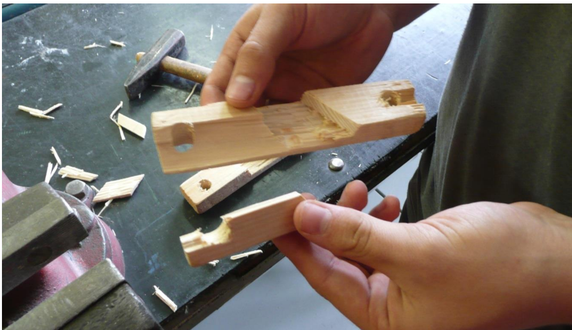
Obrázek 20 Prasknutí ramene při dlabání výběru
