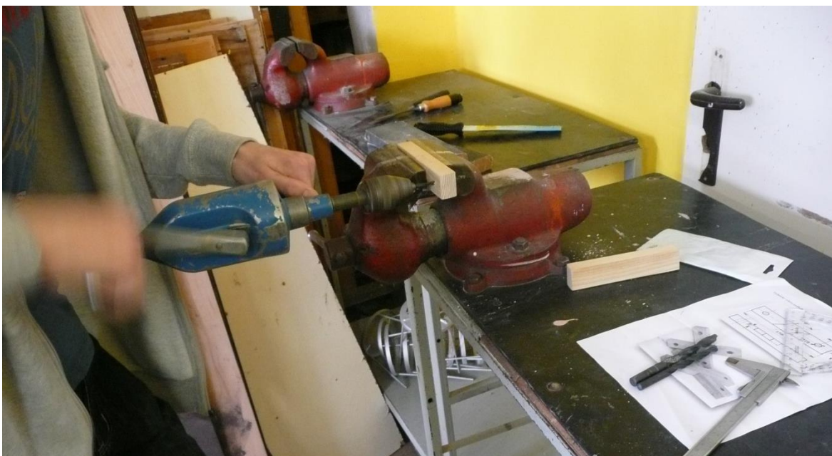
Obrázek 27 Předvrtání otvoru \varnothing 10 mm menším vrtákem
