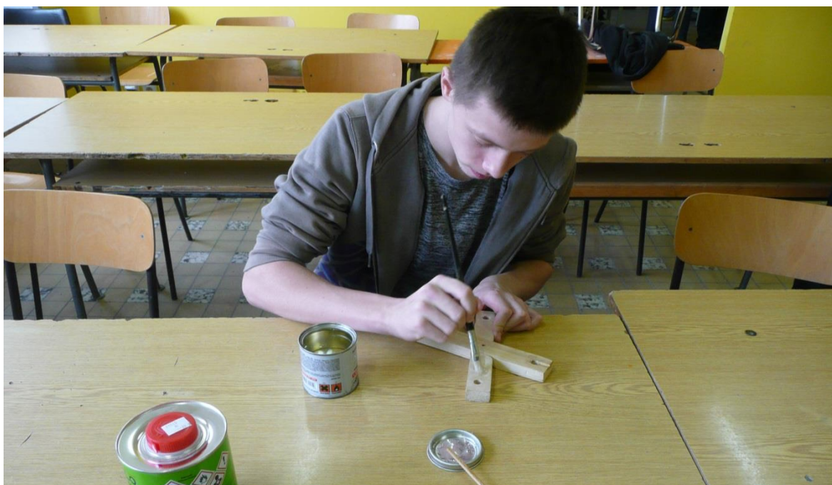
Obrázek 23 Lakování podložky pod hrnec
