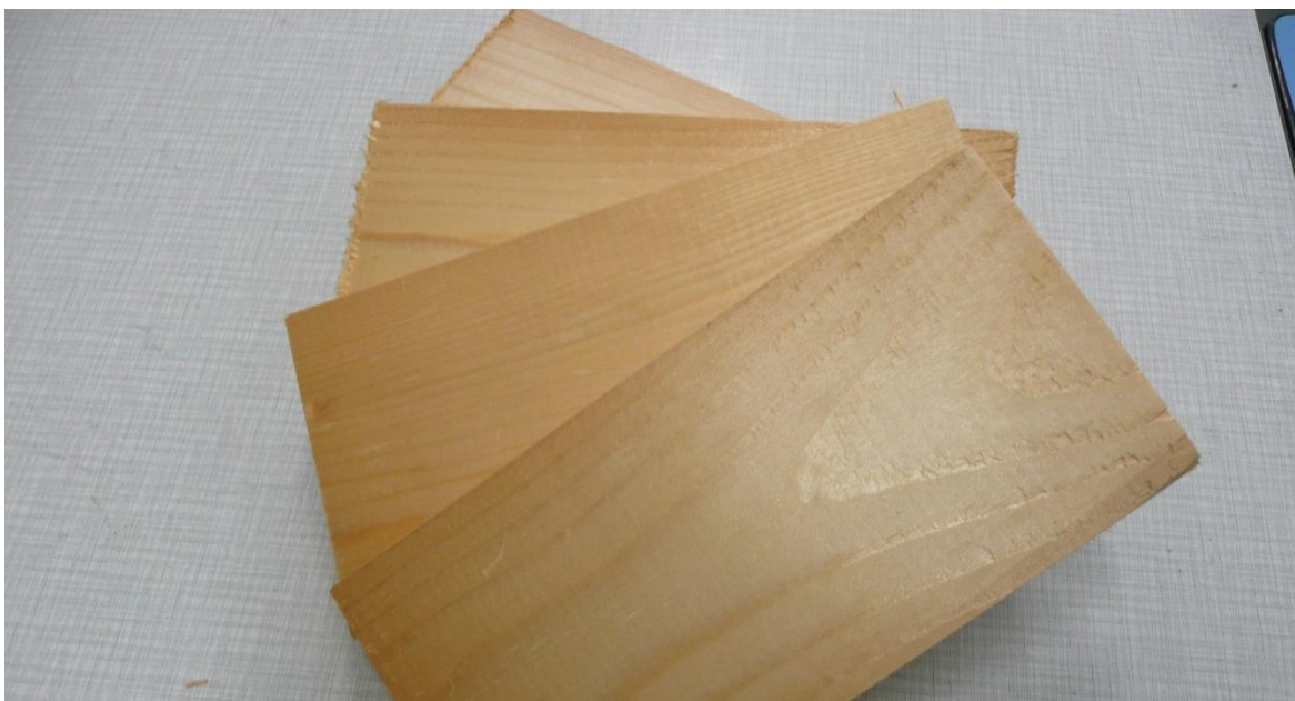
Obrázek 15 Materiál pro výrobu podložky pro hrnec (200x100x20)
