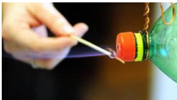
Obrázek 66: Zapálení lihových par v PET lahvi. [69]
