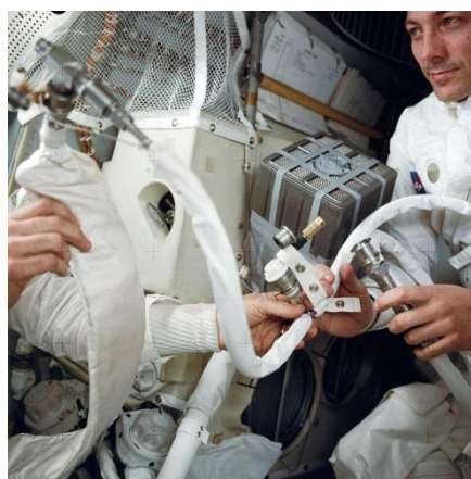
Obrázek 56: Posádka Apolla 13 při konstrukci improvizovaného filtru oxidu uhličitého. [66]
