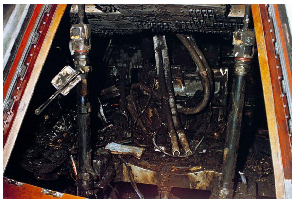
Obrázek 26: Kabina Apolla 1 po požáru. [35]
