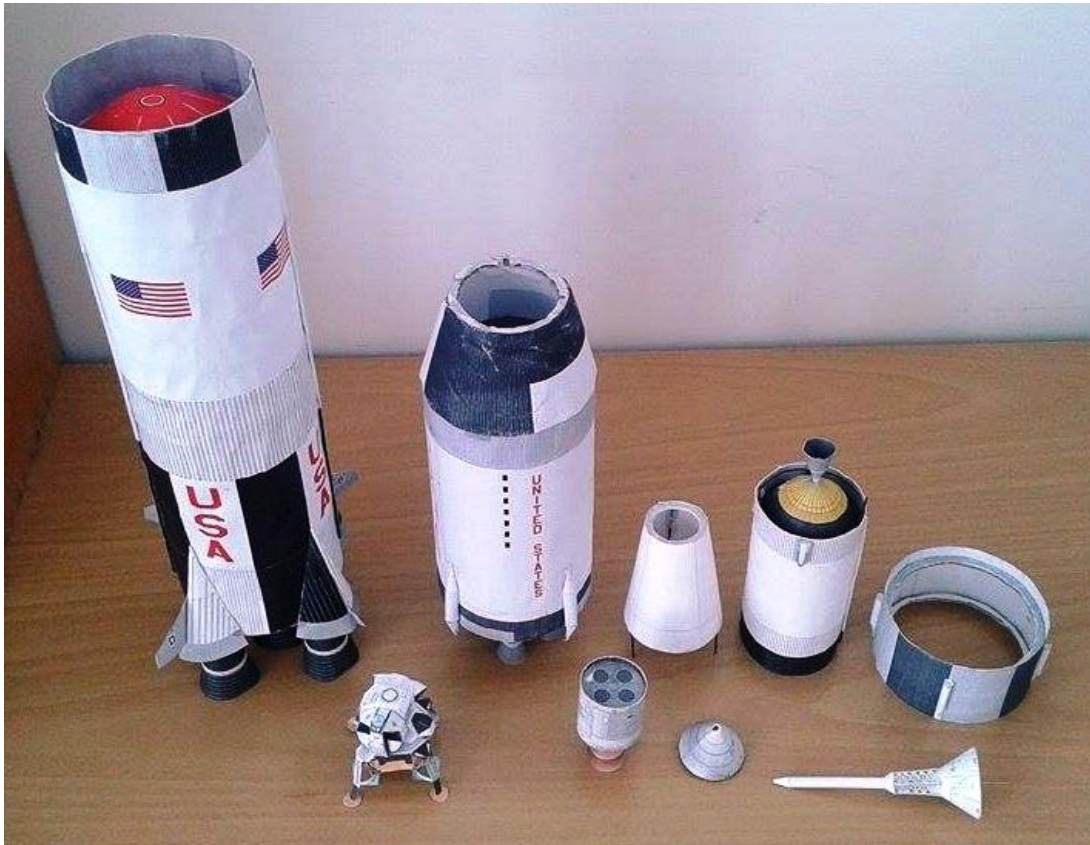
Rozložený model rakety Saturn V. Zleva: S-IC, LM,S-II, SM, SLA, CM, S-IVB, LES, mezistupeň.
