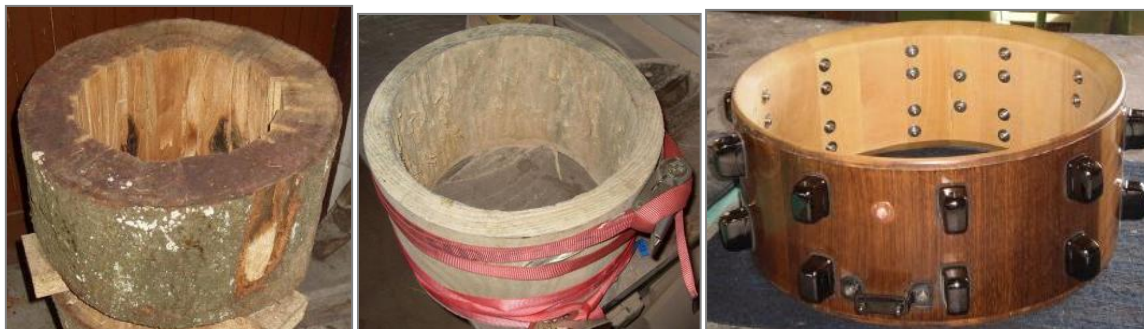
Obr. č. 47 – a) vydlabaný špalek; b)opracovaný vydlabaný špalek; c) odýhovaný lub
