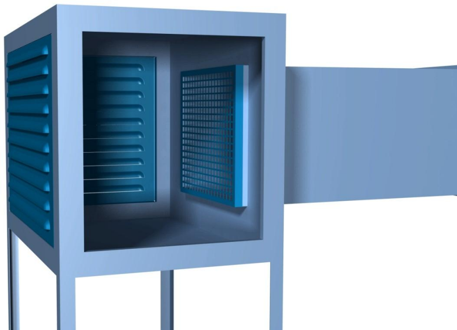
Obr. 41 - Vstup do vzduchového potrubí s ochranným sítom
