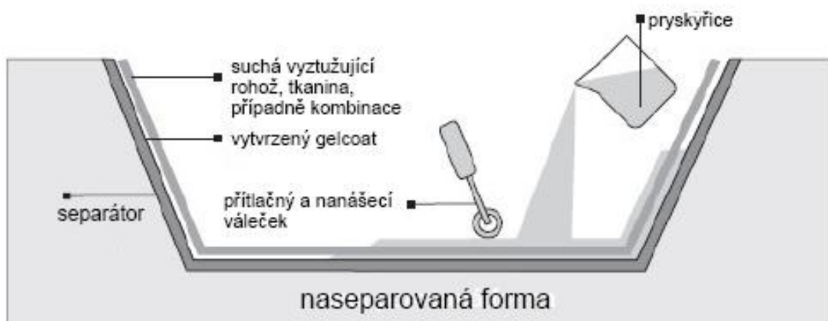
Obrázek 47: Schéma kontaktního laminování 47
