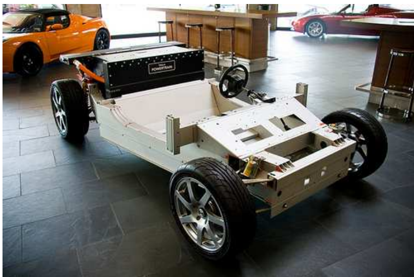
Obr. 18. Upravený podvozek Lotus Elite 18
