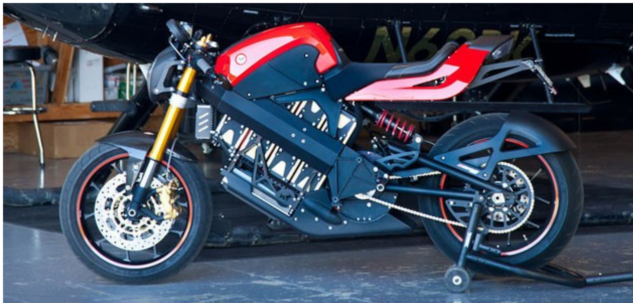
(obr 2.4.7) Baterie uchycena na dvou paralelních trubkách rámu. 37
