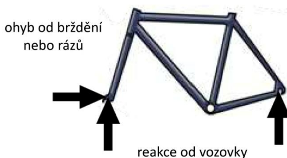
Obr. 32 Dynamické zatížení rámu kola (ohyb, tlak) (49)
