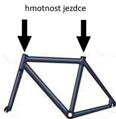
Obr. 30 Statické zatížení rámu kola (ohyb, tlak) (49)
