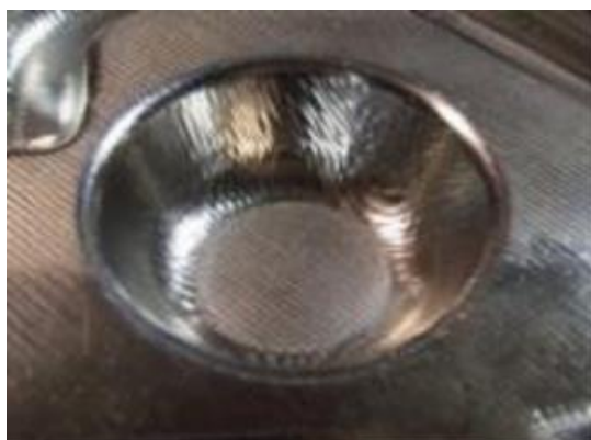
Obr. 1-4 Nevhodný povrch součásti způsobený špatnou volbou interpolací a přesností. [4]
