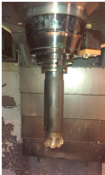
Obr. 2-8 Čelní válcová fréza rohová Safety na prodlouženém trnu ISO 40.
