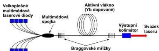
Obr. 3-13 Schéma zdroje vláknového laseru [12]
