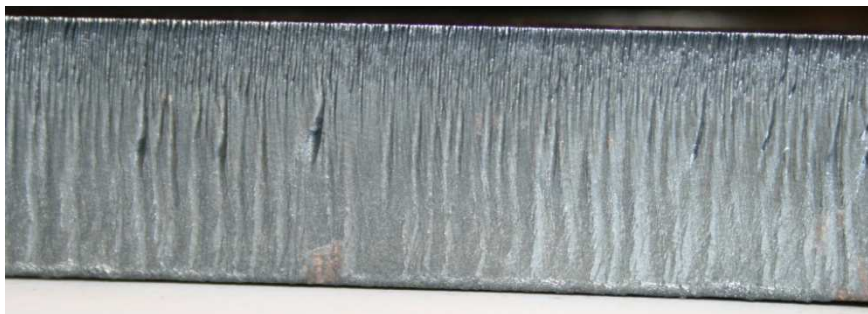
Obr. 4-6 Povrch řezu při metodě řezání plamenem
