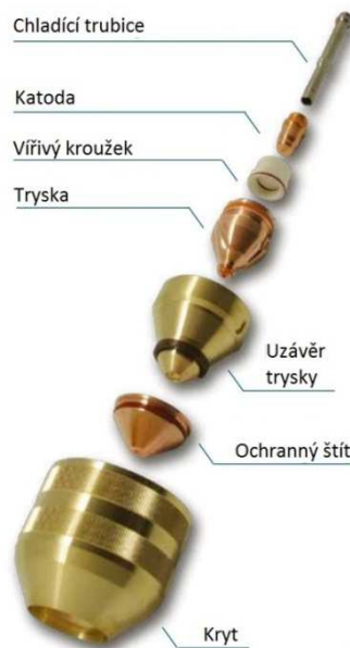
Obr. 4-4 Rozstřel dílů hořáku PerCut 210 [18]
