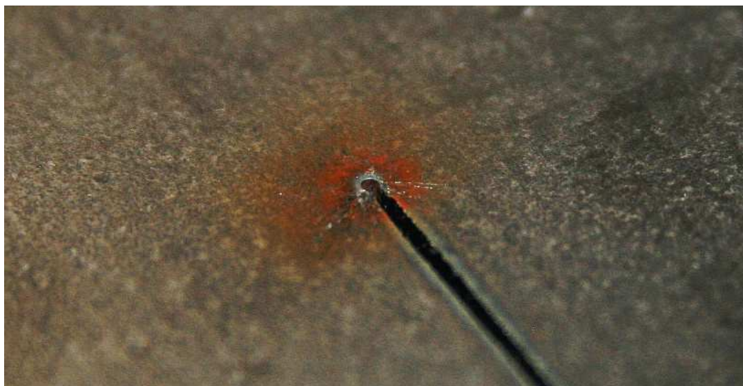
Obr. 3-15 Ukázka řezné spáry a místa zápalu
