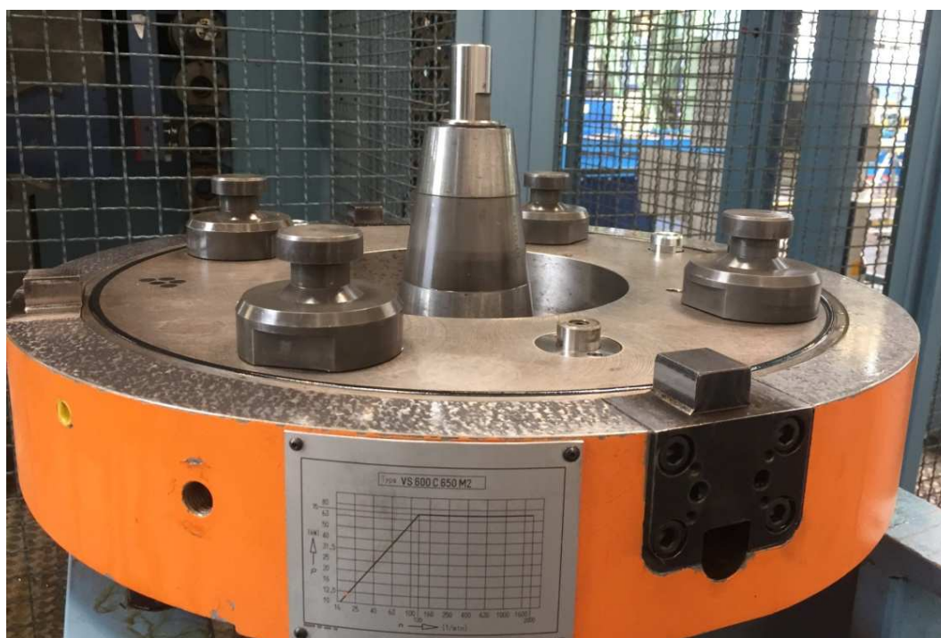
Obrázek 13: Upínací systém přídavného zařízení [1]
