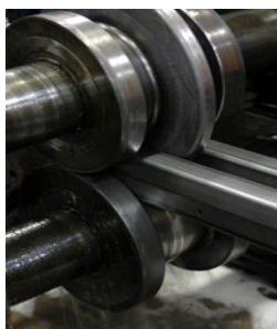
Obr.5 a), b), c) válcovací stolice v jednotlivých fázích procesu [4]
