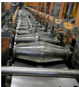
Obr.5 a), b), c) válcovací stolice v jednotlivých fázích procesu [4]
