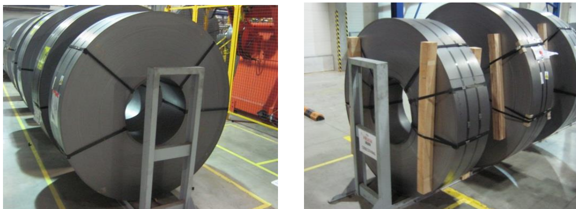
Obr.19 a), b) Svitky materiálu DP1180 pro nárazníky B232 [9]
