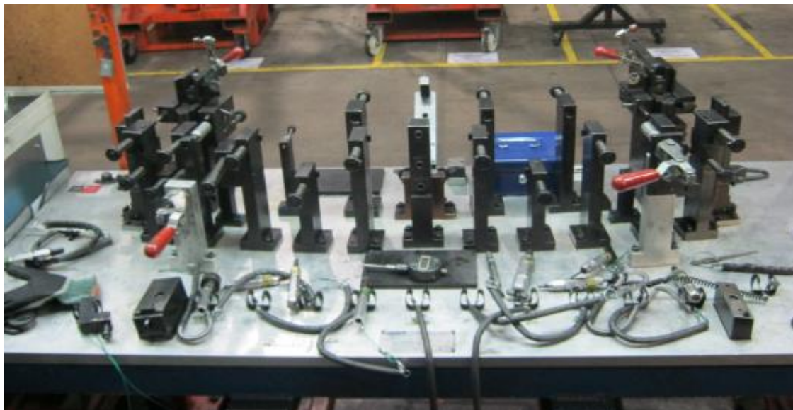
Obr. 20 Původní kontrolní přípravek č. S13660I003 na měření nárazníků B232 [9]
