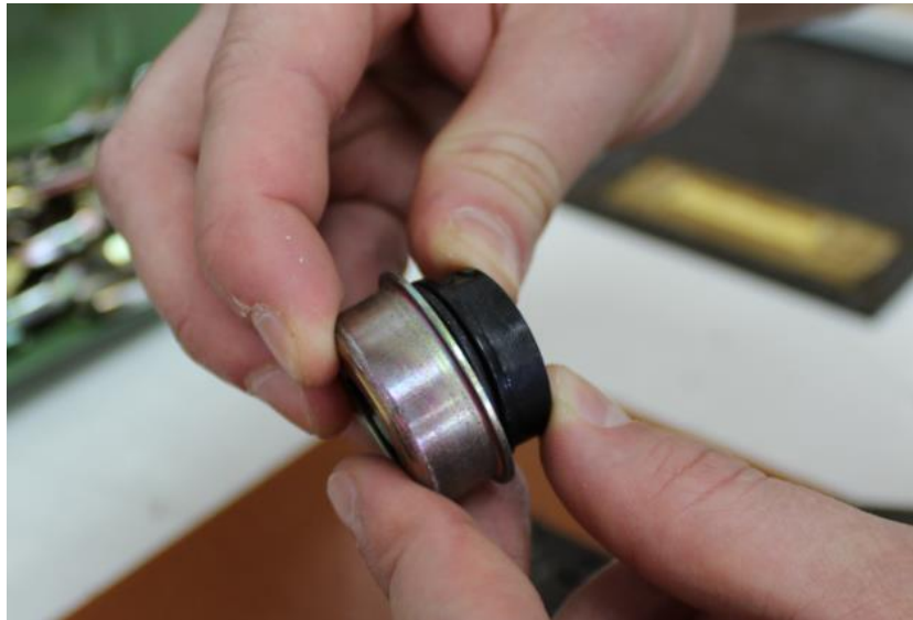
Obrázek 16 Vkládání pístu do válečku
