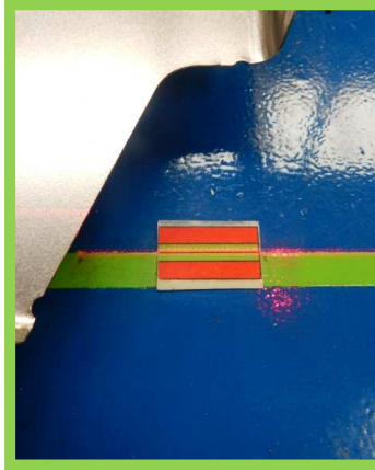
Obrázek 6-5 Laser určující pozici sealeru [11]
