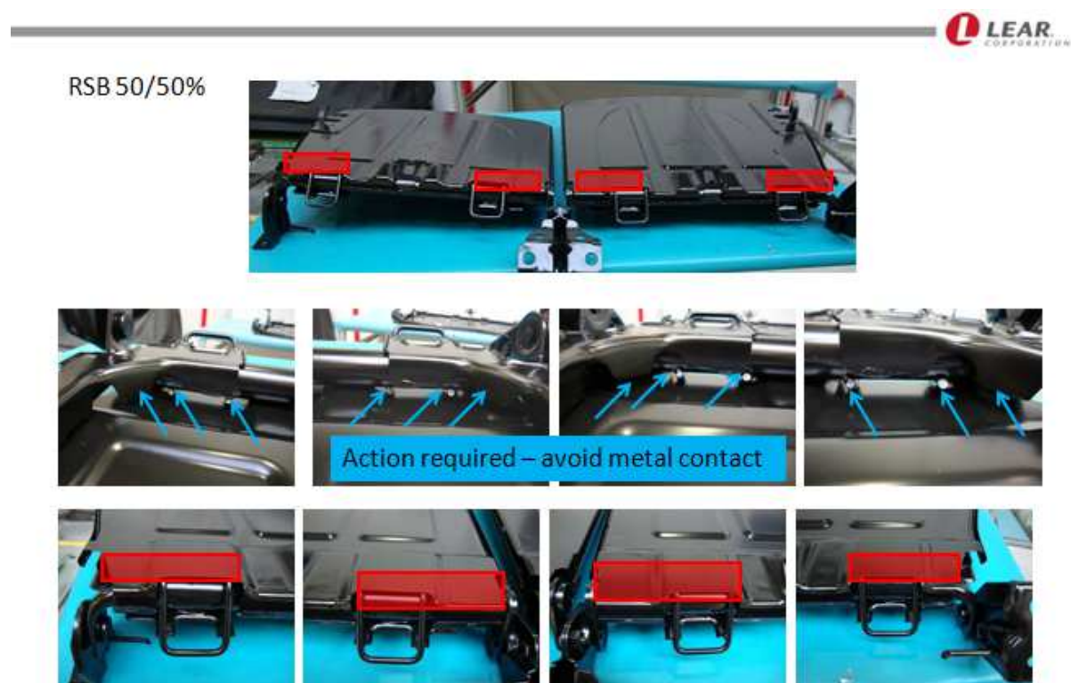
Obrázek 4-3 Kontakt plechu se spodní trubkou RSB 100 [11]
