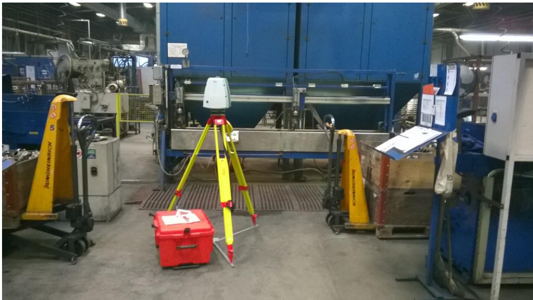
Obr. 28 Sestavená skenovací stanice - hlava, stojan, nástavec
