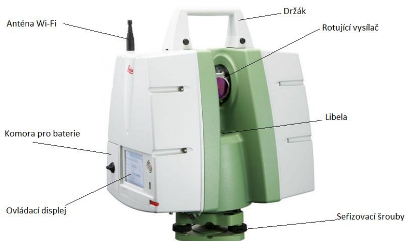
Obr. 8 Popis skenovací hlavy
