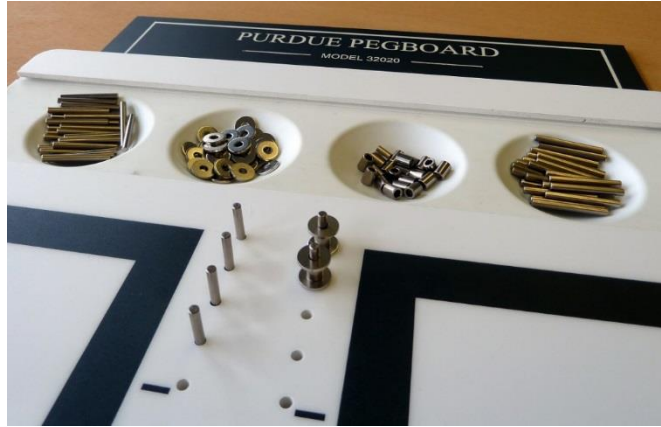
Obrázek 2-2: PPT – ukázka umísťování kolíků levou rukou a sestavy (zásobníky jsou organizovány pro testování praváka)
