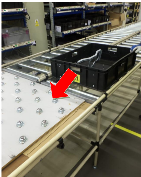
Obr. 3-5 Nájezd přepravky na kuličkový stůl
