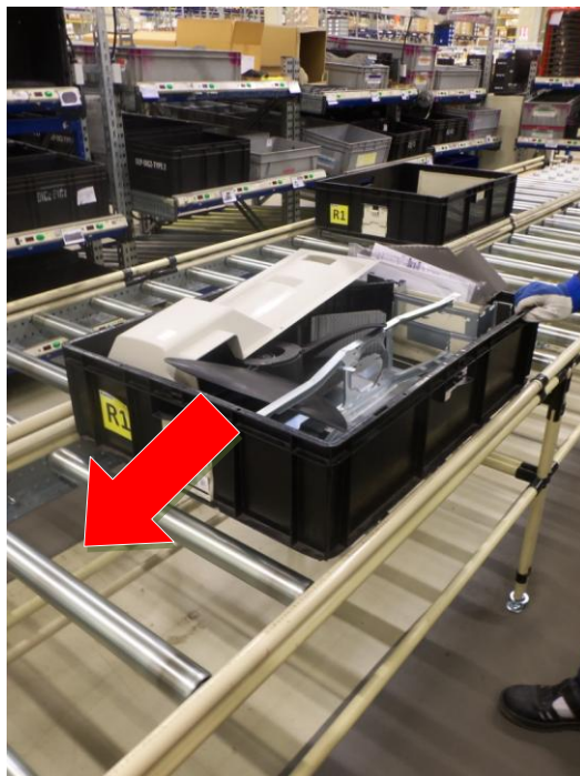
Obr. 3-4 Pohyb přepravky po dopravníku
