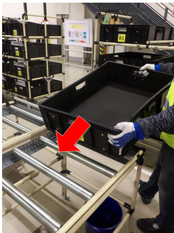
Obr. 3-3 Položení přepravky na dopravník
