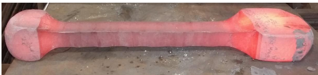
Obr. 35 Vykovaný předkovek podle varianty D
