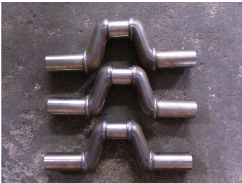
Obr. 50 Svařované zkušební sestavy pro zkoušky torzním kmitáním
