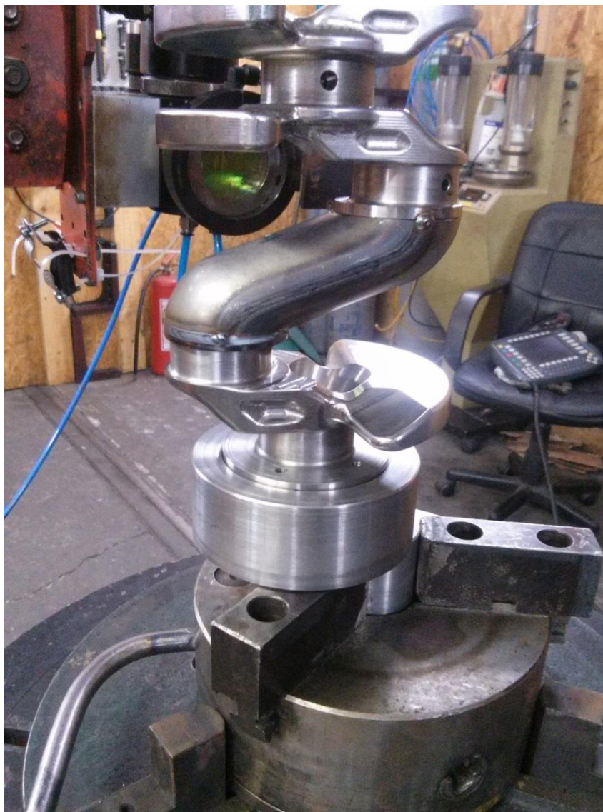
Obr. 53 Ukázka svařování klikové hřídele, která je upnuta v přípravku pro svařování „vyosení“
