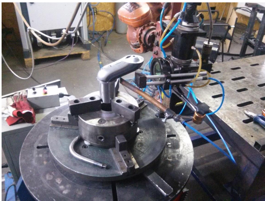
Obr. 49 Svařování zkušební sestavy pro cyklické zkoušky sřídavým ohybem
