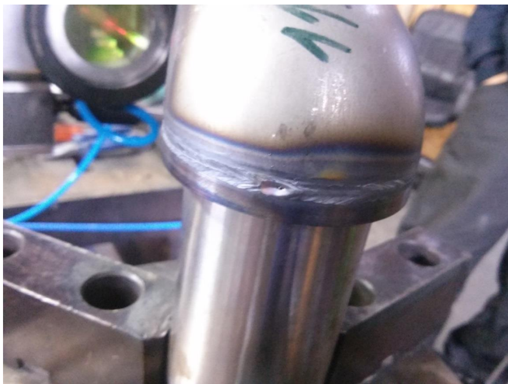
Obr. 47 Ukázka svaru po prvním kroku (zde je patrný „propad“ na konci obvodového svaru)
