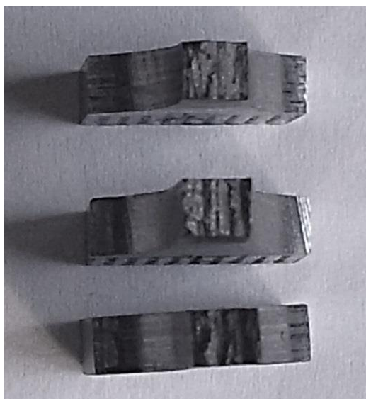
Obr. 29 Lomové plochy vzorků po tahových zkouškách
