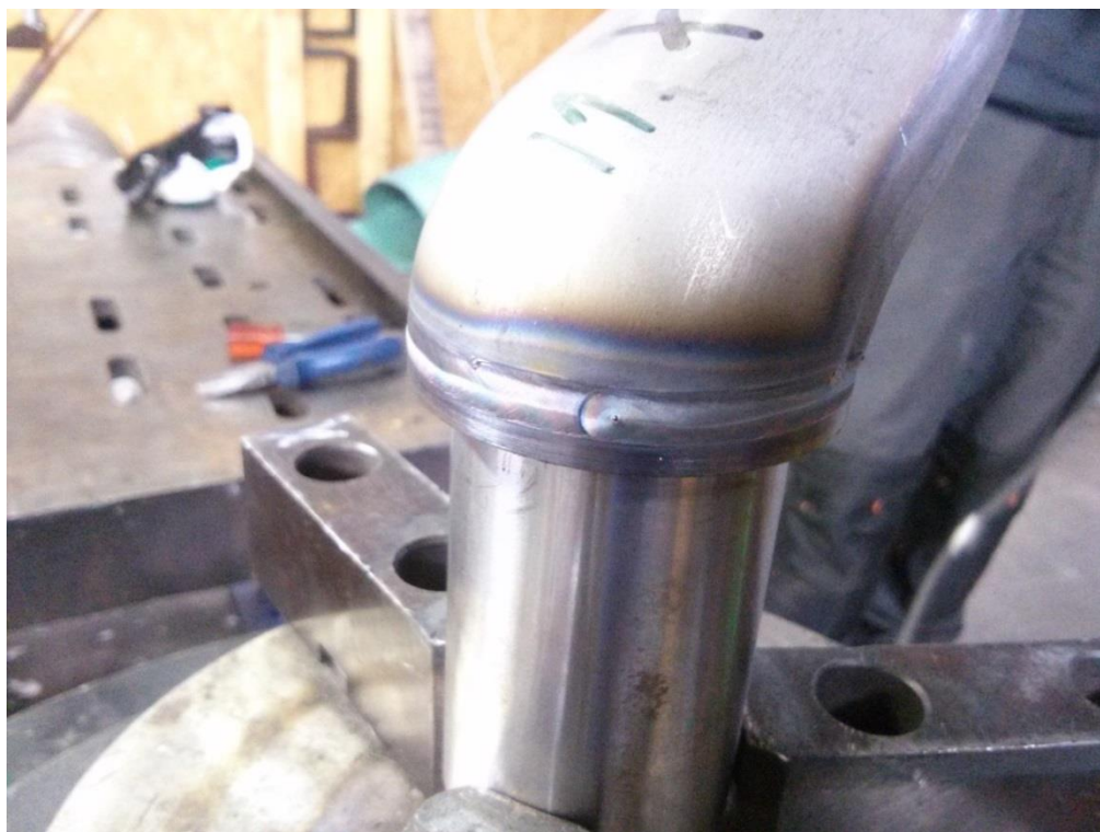
Obr. 48 Ukázka svaru po druhém kroku (hladký povrch)
