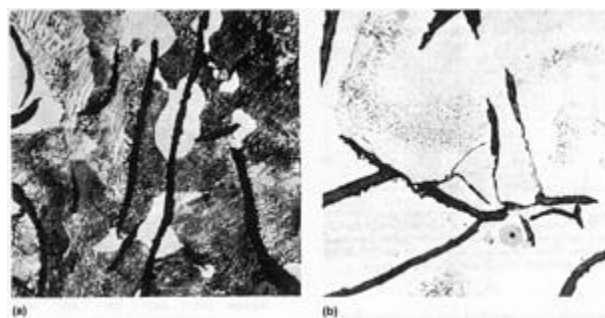
Obrázek 6 – šedá litina před (vlevo) a po proběhnutí feritizačního žihání (vpravo)[3]
