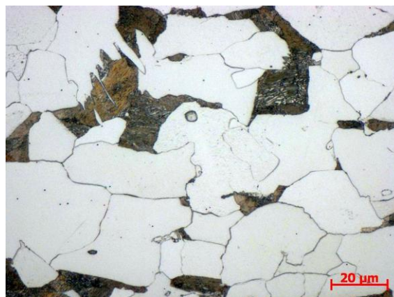
Obr. 5-4 Feriticko – perlitická struktura oceli S355J2, vzorek C, leptáno Nital 3 %, zvětšeno 500x, světelný mikroskop
