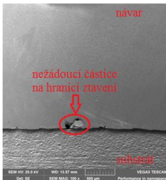
Obr. 5-14 vzorek B, leptáno Nital 3 %, zvětšeno 100x
