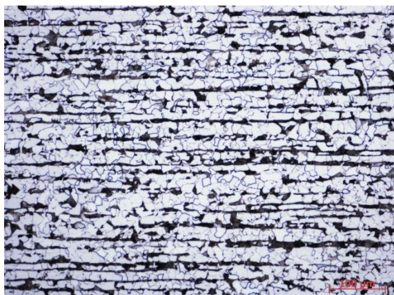
Obr. 5-3 Feriticko – perlitická struktura oceli S355J2, vzorek A, leptáno Nital 3 %, zvětšeno 100x, světelný mikroskop
