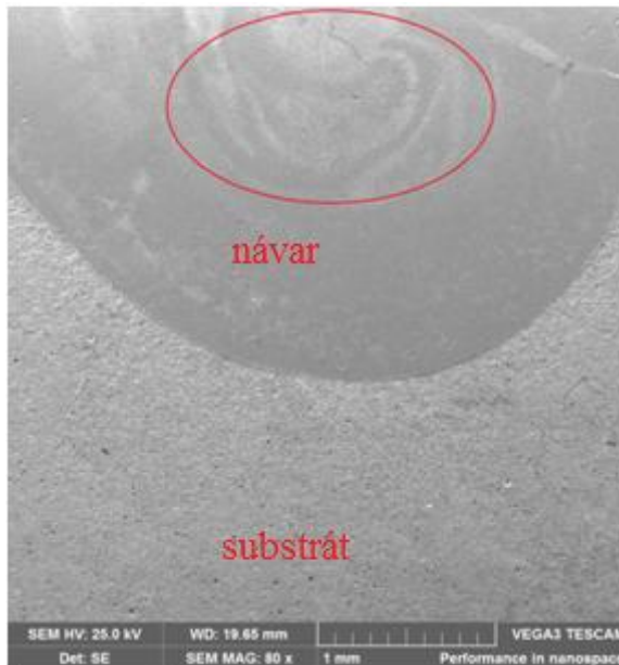
Obr. 5-10 Oblast s rozdílným chemickým složením v návaru, vzorek G, leptáno Adler, zvětšeno 80x
