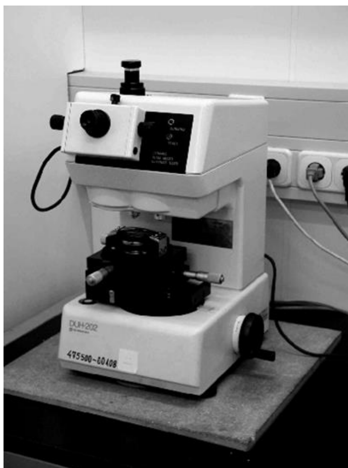
Obr. 13 – Nanoindentor Shimadzu DUH 202
