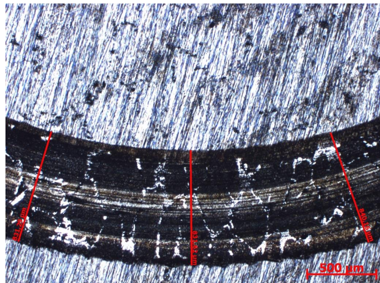
Obr. č 30 - Stopa na vzorku austenitizační teplota 1010°C se zjevnými stopami segregovaných karbidů, zachyceny 3 měření, zvětšení 25x
