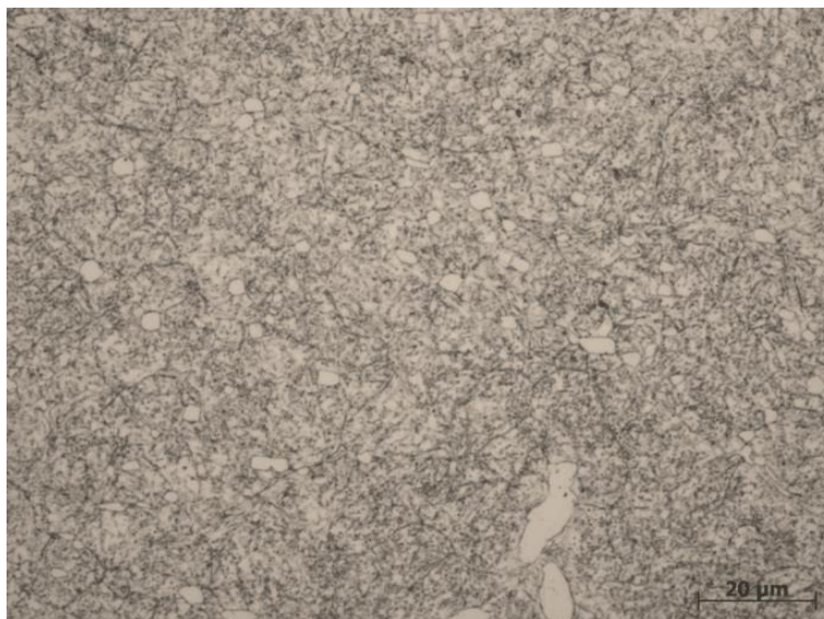
Obr. č 23 - Detail struktury vzorku s rozmístěnými sekundárními karbidy v matici popuštěného (kubického) martenzitu, ve spodní části snímku zřetelné nerozpuštěné primární karbidy; Zvětšení 500x
