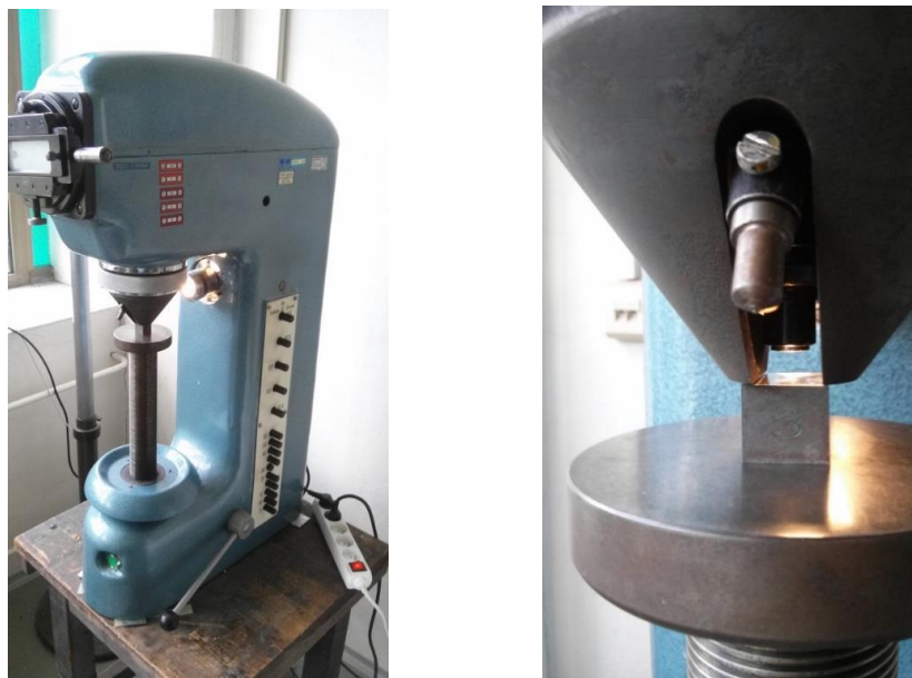
obr. č 10, 11 - Zkouška tvrdosti
