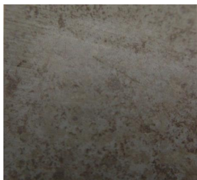
Obr. 24 – Vzorek B20 loužený v murakami
