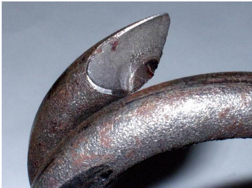
Obr. 1 - Únavové porušení válcové pružiny [9]
