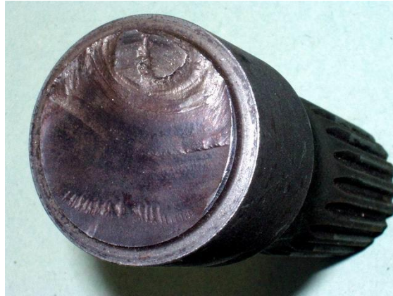
Obr. 4 - Únavový lom drážkovaného hřídele [9]
