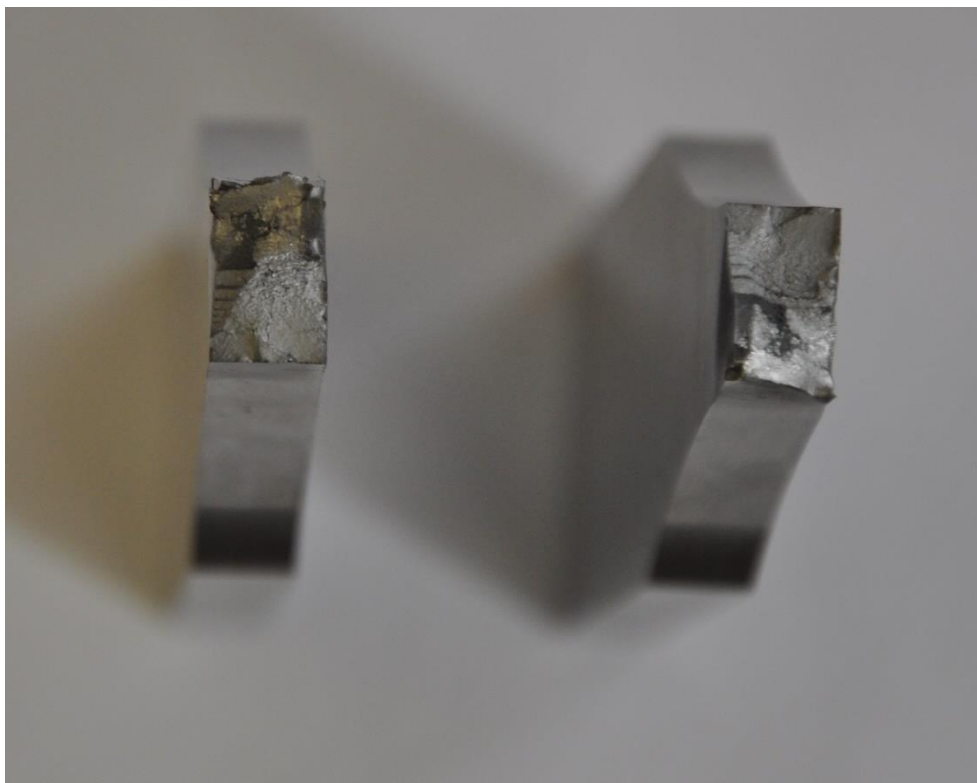
Obr. 35 - Lom vzorku po nakmitaných 2707 cyklech
