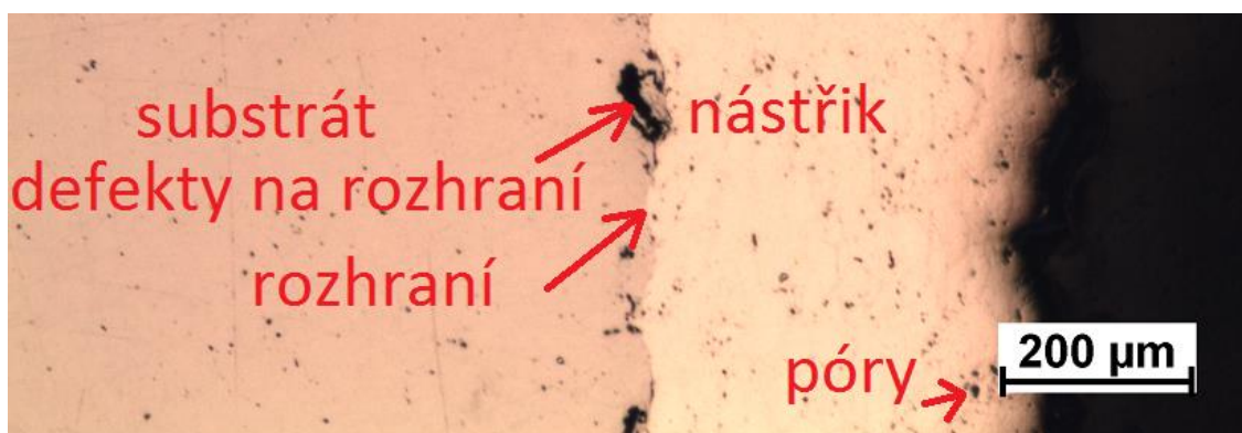
Obr. 6.1: Mikrostruktura nepřetaveného HVOF nástřiku
