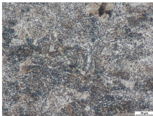
Obr. 42 - Zrychlené žhání (ASR) – 3x15s/760°C, chlazení na vzduchu, 232 HV10
