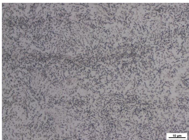
Obr. 41 – Žhání na měkko (ZM) - 750°C/4h, chlazení v peci, 179 HV10
