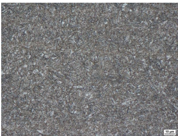
Obr. 52 – ASR 860 P, 447 HV10
