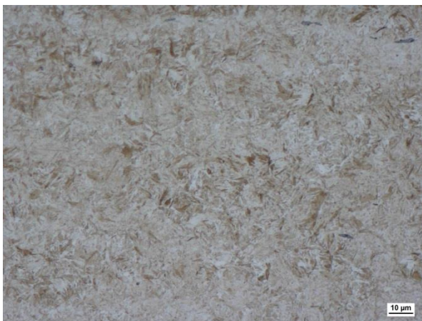
Obr. 50 – ASR 860 K, 706 HV10
