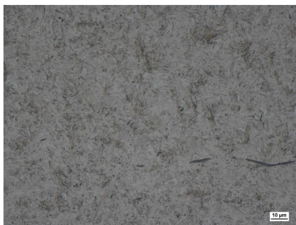
Obr. 44 – ASR 800 K, 677 HV10
