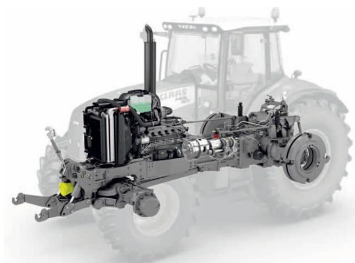
Obrázek 3: Polorámová konstrukce traktoru Class Axion [8]
