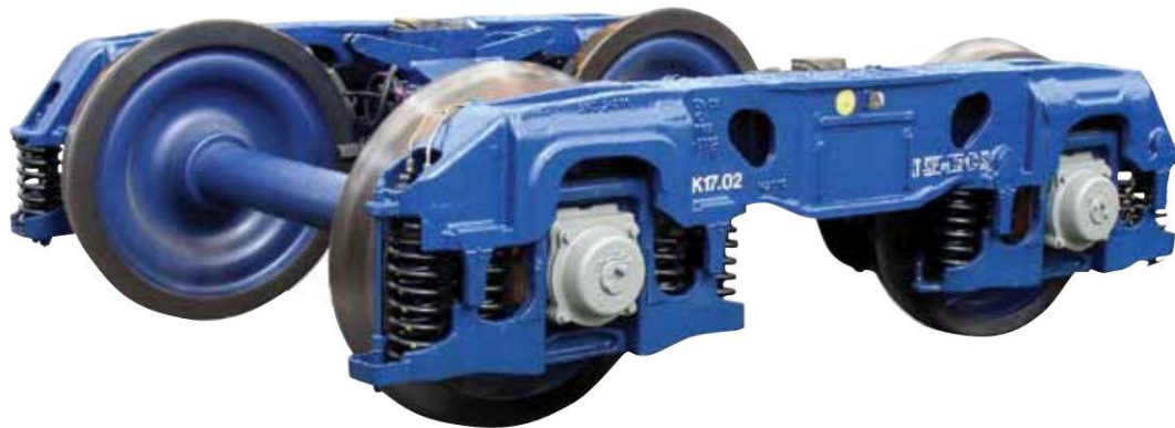
Obrázek 1.28 Verze podvozku AMI III pro nápravové zatížení 25t[3]
