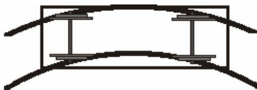
Obr. 1.1 Nevýhodné postavení náprav v oblouku[12]
