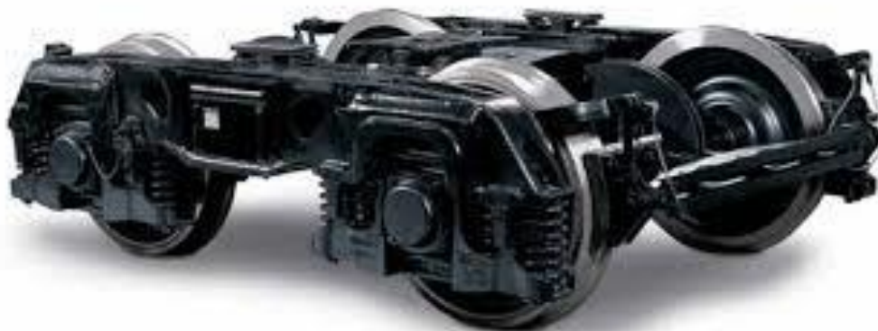
Obrázek 1.29 Verze podvozku AMI III pro nápravové zatížení 30t [3]
