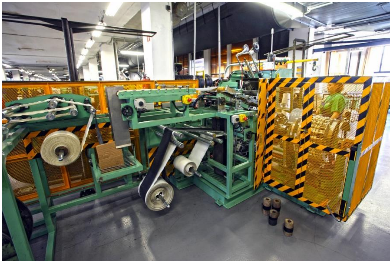
Obr. 28 - Konfekční stroje spojují běhoun, kord a patní výztuhu [22]
