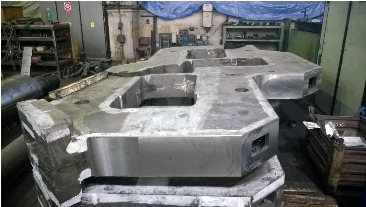
Obr. 39 - Částečně opracovaný odlitek stojanu
