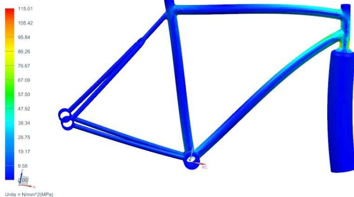
Obrázek 39 - Zadní vidlice Y, náraz
