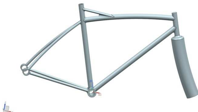
Obrázek 41 - Vyztužení u sedlové trubky
