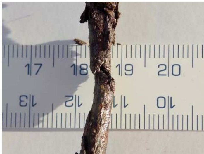
Obrázek 69: Značně zkorodovaná brzdová trubka [9]
