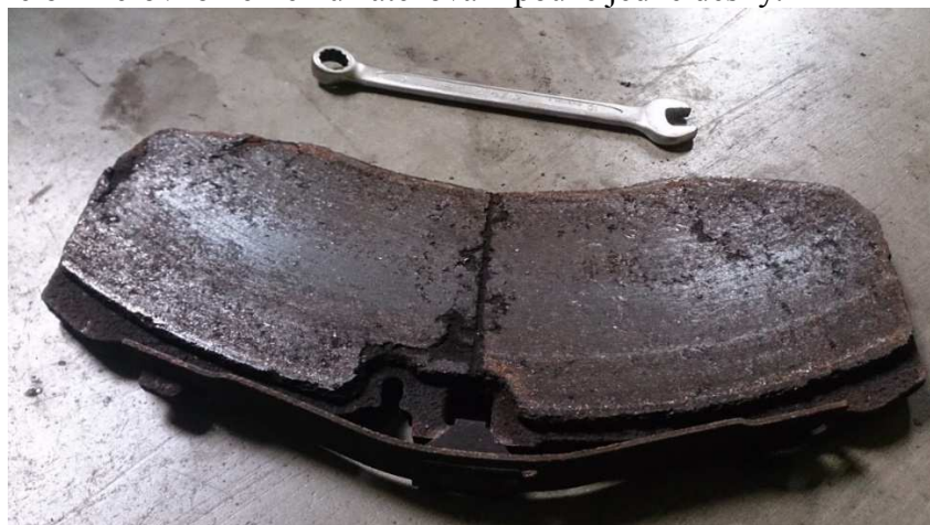
Obrázek 64: Opatřebená brzdová deska tahače IVECO Stralis s patrným odštěpováním třecího materiálu. (10 mm klíč pro představu rozměru)
