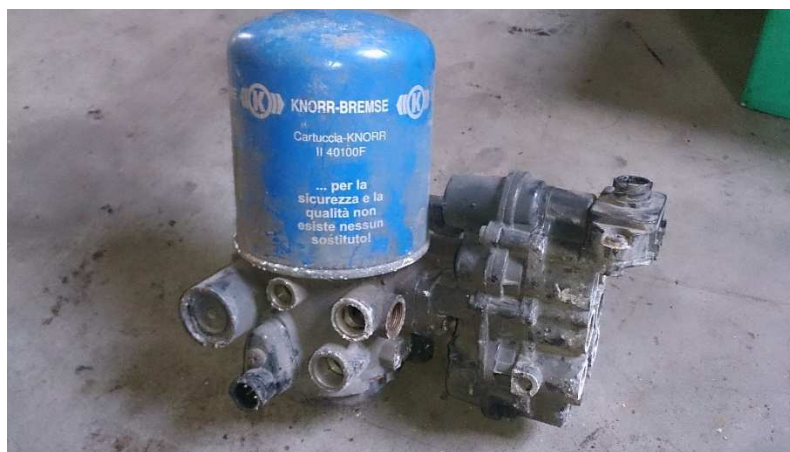
Obrázek 71: Vadný vysoušeč s čtyřokruhovým pojistným ventilem
