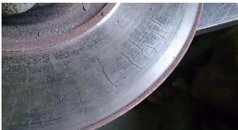
Obrázek 65: Brzdový kotouč s patrnými teplotními trhlinami
