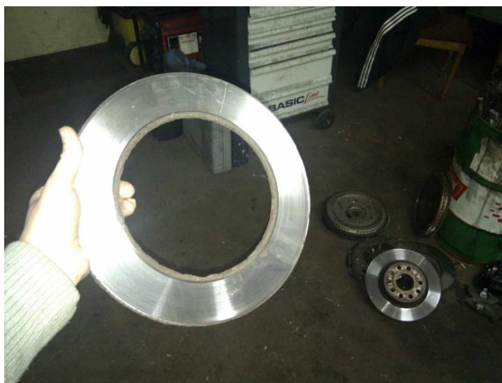
Obrázek 66: Brzdový kotouč, u kterého došlo vlivem koroze k oddělení činné plochy
