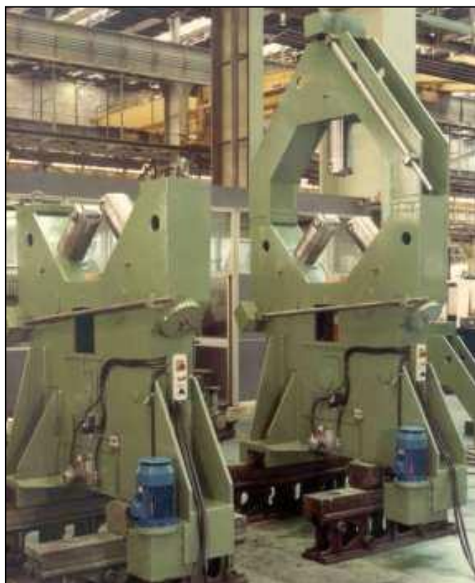
Obr. 10. Opěra s odnímatelnou horní částí
