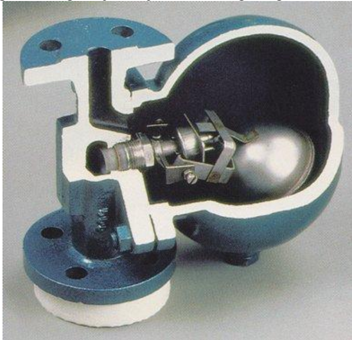
Obrázek 4-6 Plovákový odvaděč kondenzátu [6]
