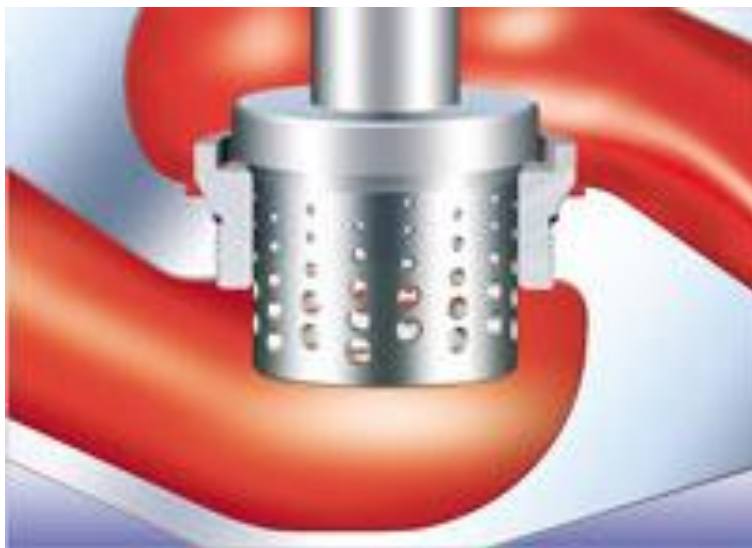
Obrázek 4-8 Detail děrované kuželky [1]
