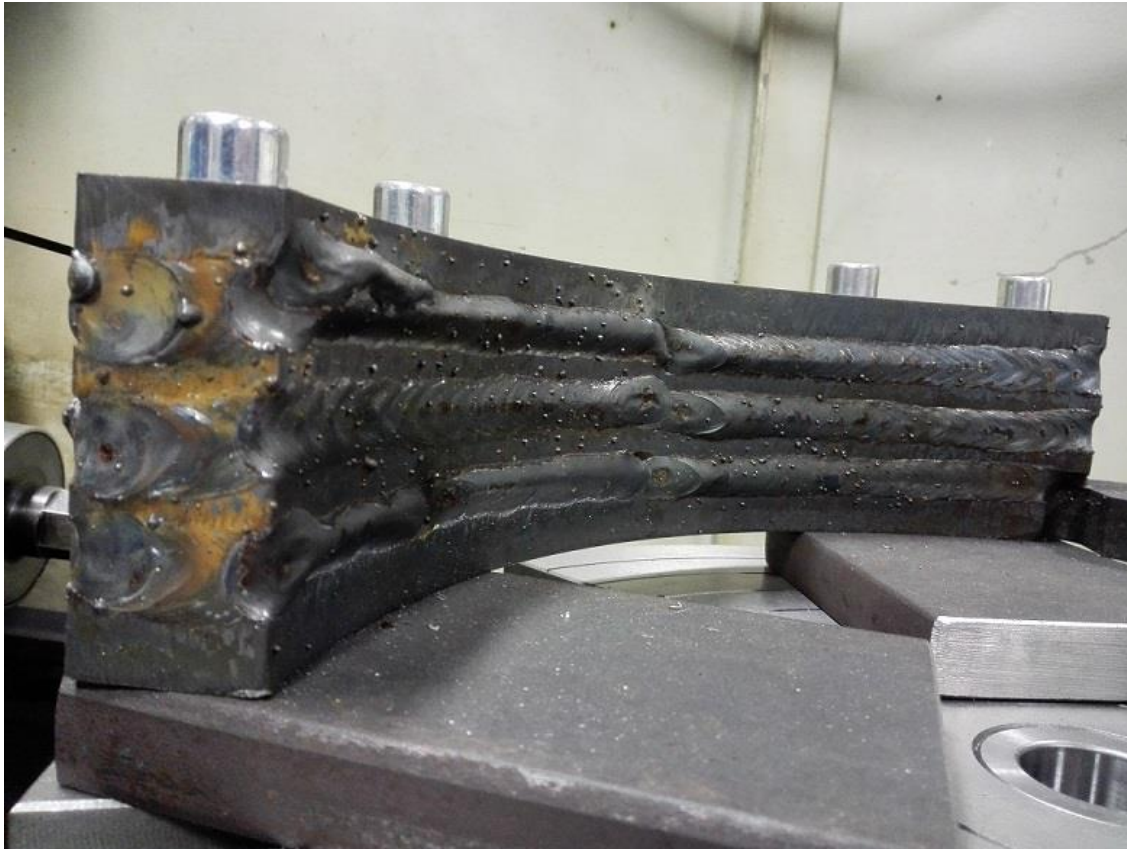
Obrázek 52 Svařený přípravek, upnutý pro frézování – 2
