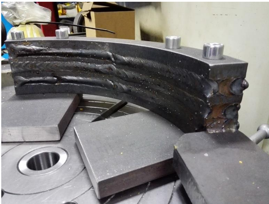
Obrázek 51 Svařený přípravek, upnutý pro frézování - 1
