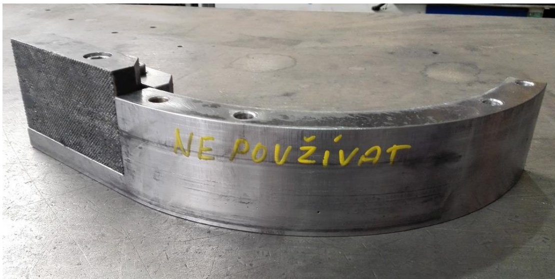
Obrázek 54 Kompletně svařený a smontovaný přípravek 2
