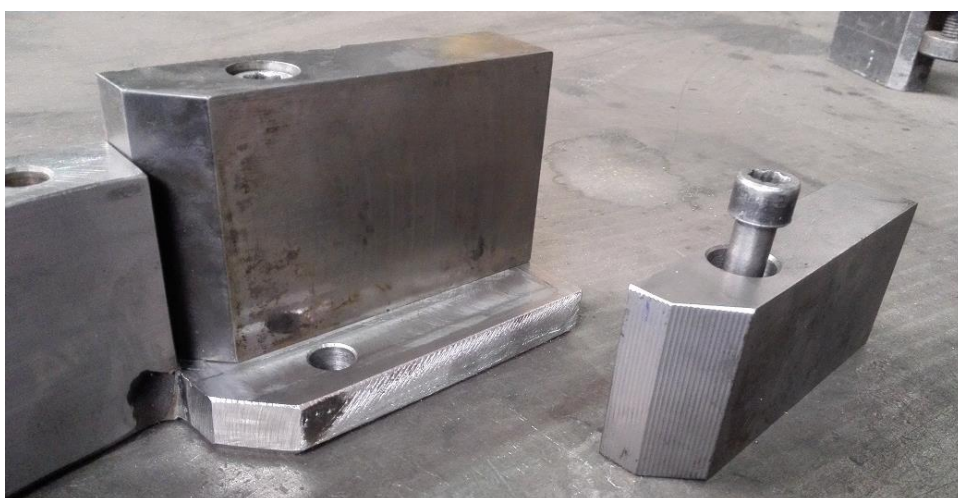
Obrázek 56 Kompletně svařený přípravek spolu s drážkovanou deskou a podložkou
