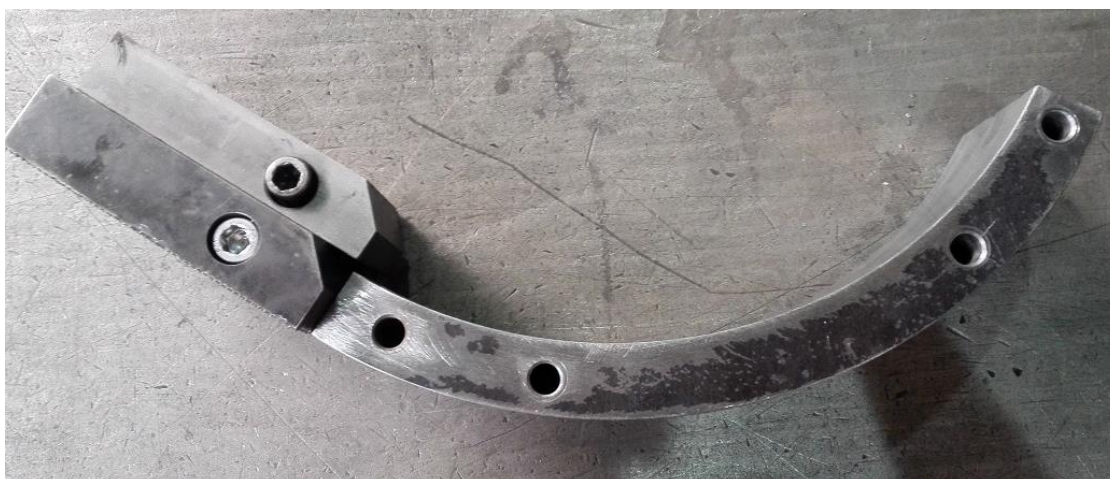
Obrázek 55 Kompletně svařený a smontovaný přípravek 3
